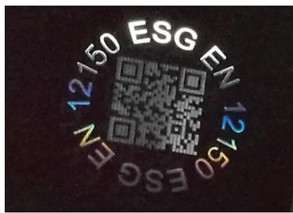
Hi-Res-LASER-Beschriftung auf gehärtetem Glas
