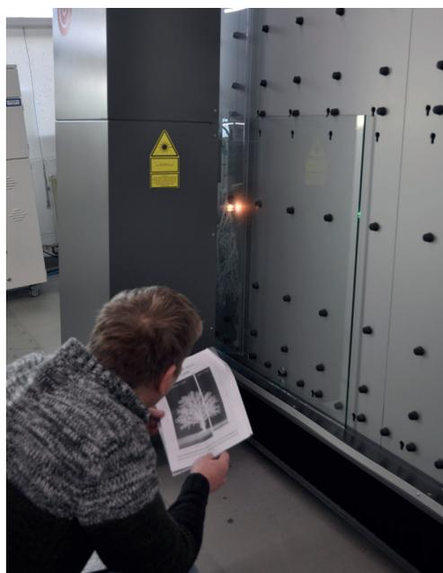
cericom c-vertica: Laserbearbeitungssystem für Flachglas in Schrägbettausführung.
