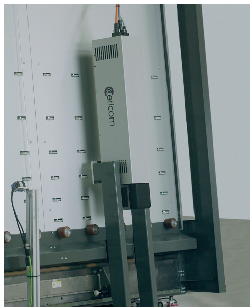
c-mark-Modul in Kombination mit Vertikal-Glasbearbeitungsmaschine c-vertica Bild 69c90098
