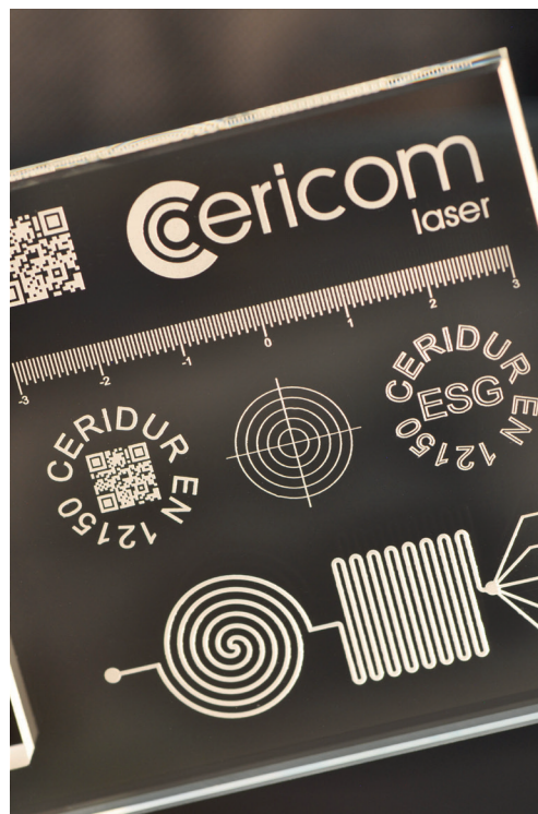
Mit dem Lasermarkierer erzeugte Beschriftungen Bild 69c90096
