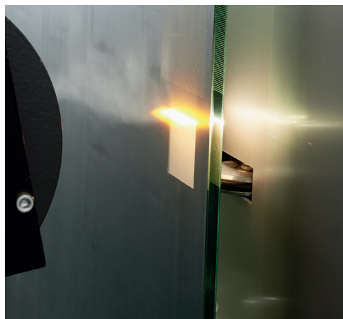
Spiegelentschichtung mit dem Laserstrahl – auf einer cericom c-vertica. Bild 69c00074
