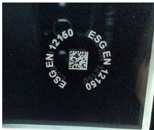
Mit dem Lasermarkierer erzeugter 2D-Barcode. Bild 69c00067
