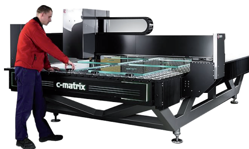
Individuelle, auftragsbezogene Glasbearbeitung mit Laserstrahlung. Bild 69c00042
